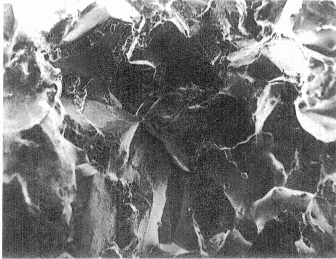
รูปที่ 11 การแตกหักในช่วงก่อนสุดท้ายเป็นแบบแตกหักตามขอบเกรน (Intergranular brittle fracture) (x 86 เท่า)
