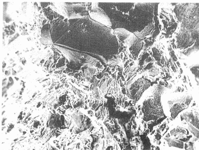
รูปที่ 10 การแตกหักในขั้นสุดท้ายแบบผ่านเกรน (Transgranular ductile fracture) ใน Cyclic creep I (x 150 เท่า)
